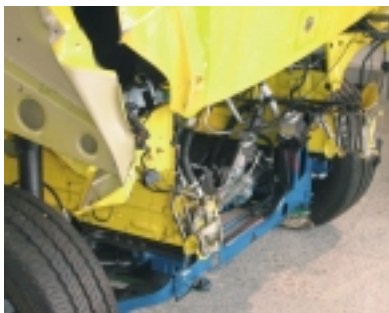
Speziell für einen Frontalaufprall wurden aufeinander abgestimmte Deformationszonen geschaffen.
